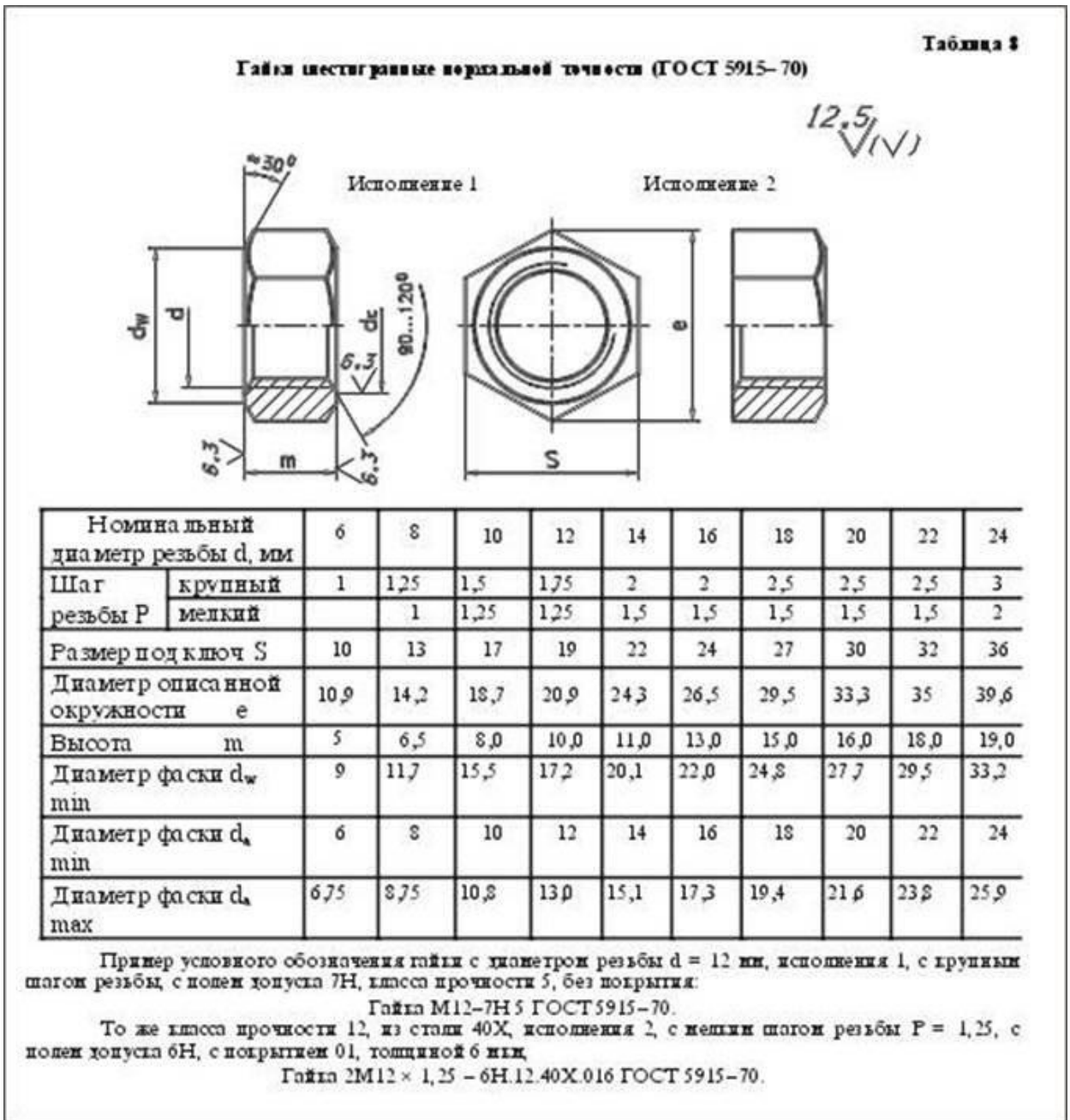
Рисунок 20.17 – Параметры гайки
