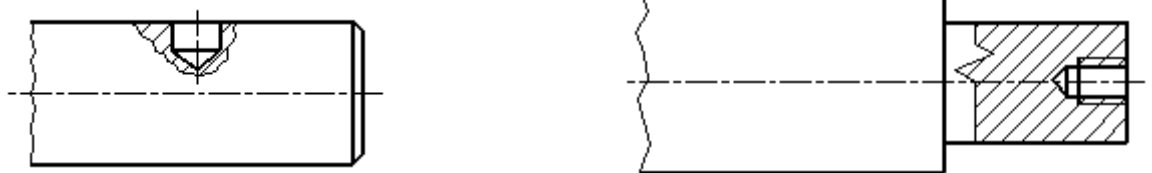
Рисунок 2.12 – Местный разрез, ограниченный сплошной волнистой линией. Рисунок 2.13 – Местный разрез, ограниченный сплошной тонкой линией с изломом.
