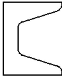
Рисунок 2.40 – Образец изображения незначительных уклонов. Рисунок 2.41 – Образец изображения незначительной конусности.
