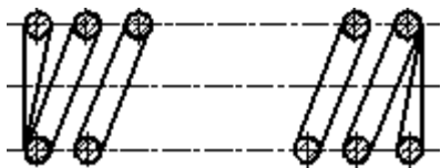
Рисунок 2.8 – Продольный разрез пружины.
