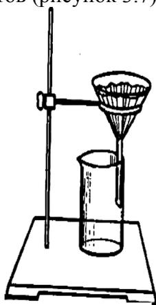
Рисунок 3.7 – Установка для фильтрования через стеклянную воронку
