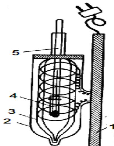
1 – подставка из изолирующего материала; 2 – кожух; 3 – рубашка с электрообогревом; 4 – капилляр с веществом; 5 – термометр
