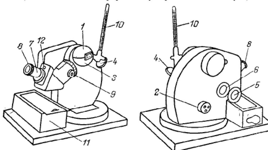
1 – верхнее полушарие измерительной головки; 2, 9 – маховики; 3 – нижнее полушарие измерительной головки; 4 – осветительное зеркало; 5 – зеркало для освещения шкалы; 6 – окошко; 7 – зрительная труба; 8 – окуляр; 10 – термометр;
