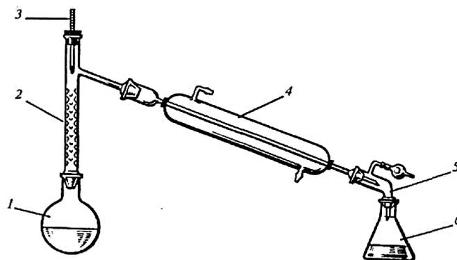
1 – перегонная колба; 2 – дефлегматор; 3 – термометр;
