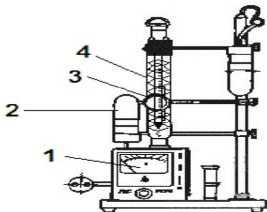
1 – вольтметр; 2 – лампа для освещения; 3 – увеличительное стекло; 4 – трубка с термометром и нагревательной спиралью
