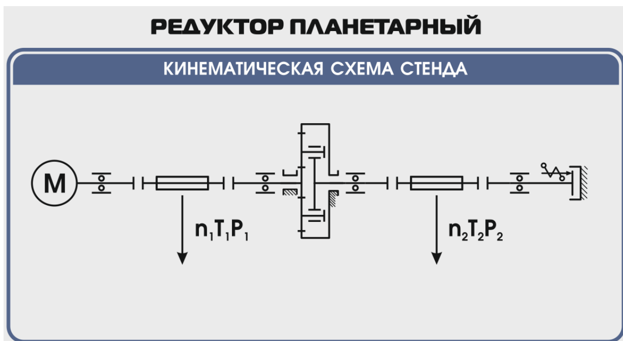
Рисунок 2. Кинематическая схема стенда
