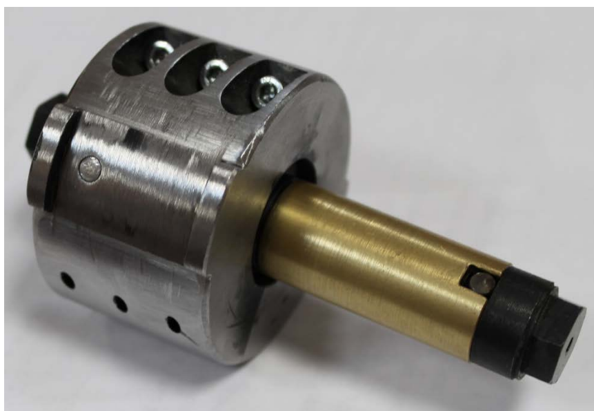
Рисунок 5. Установка вала во втулку перед запрессовкой
