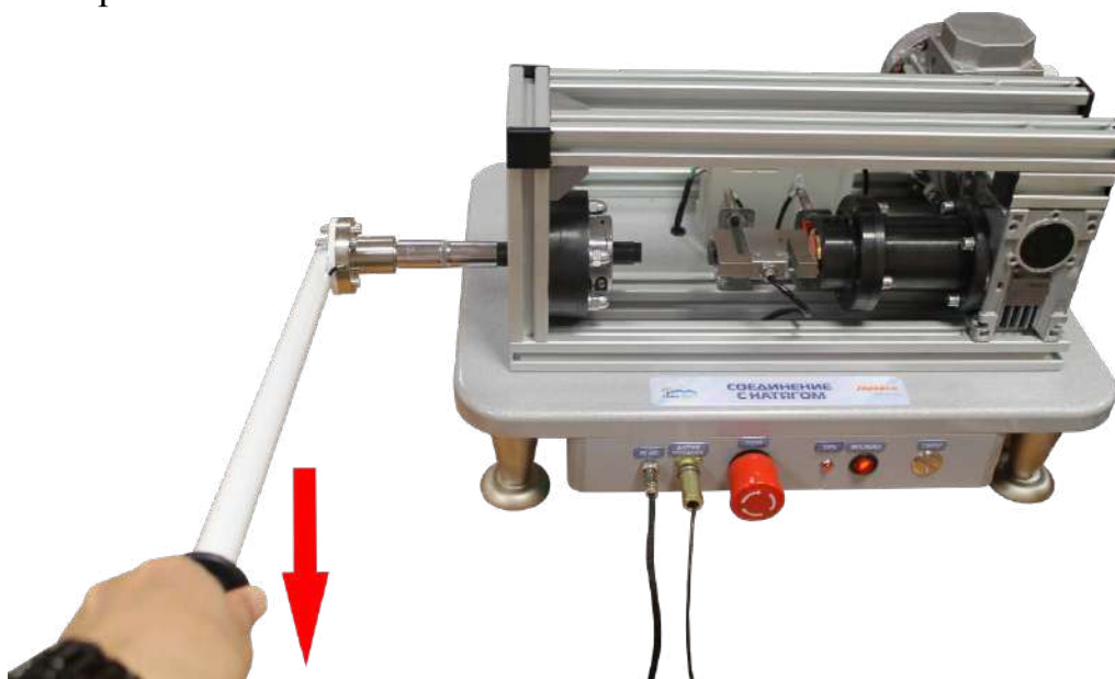
Рисунок 8. Испытание на относительный поворот.
