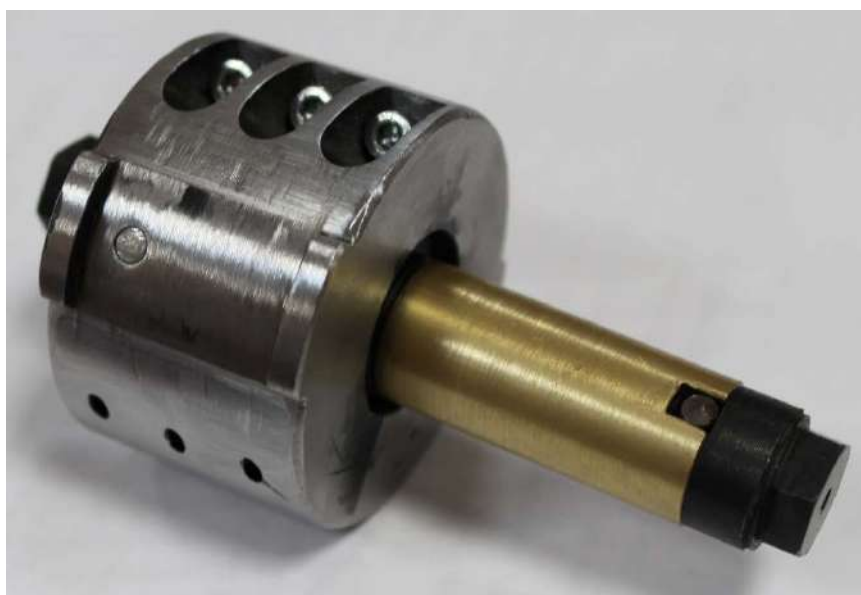
Рисунок 5. Установка вала во втулку перед запрессовкой
