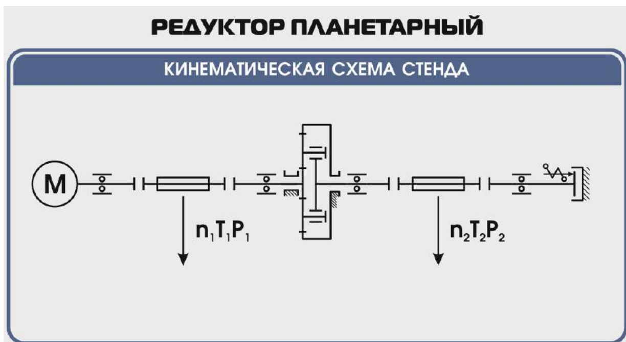
Рисунок 2. Кинематическая схема стенда
