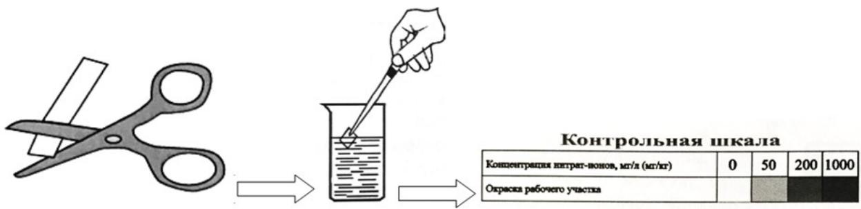
Рисунок 24. Схема выполнения анализа
