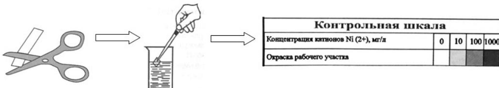
Рисунок 15. Выполнение тестирования почвенной вытяжки с применением тест-системы «Никель-тест»
