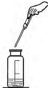
Рисунок 9. Соединение шприца-дозатора с пипеткой для титрования
