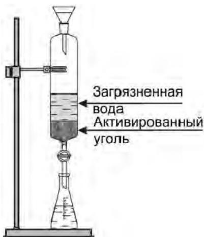
Рисунок 12. Установка для очистки воды адсорбцией
