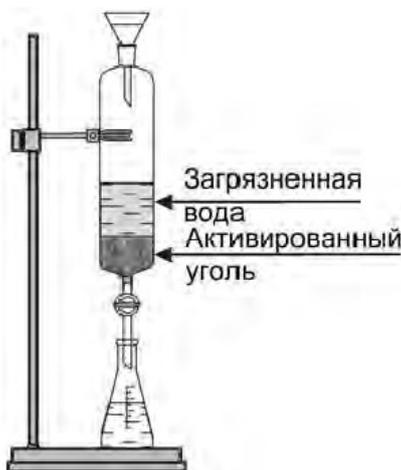
Рисунок 12. Установка для очистки воды адсорбцией
