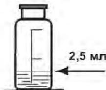
Рисунок 8. Мерная склянка, заполненная анализируемой водой
