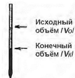
Рисунок 10. Определение израсходованного хлорида бария
