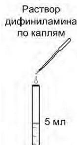
Рисунок 7. Обнаружение нитрат-ионов в исследуемой пробе воды
