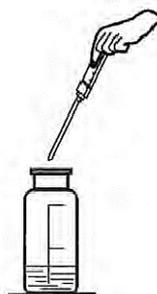
Рисунок 9. Соединение шприца-дозатора с пипеткой для титрования
