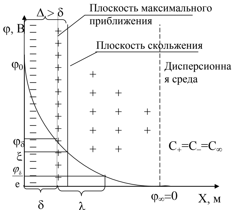
Рисунок 5.1 – Двойной электрический слой и изменение в нем потенциала с расстоянием X от поверхности частицы.
