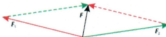
Рисунок 4.1 – Векторная сумма сил (параллелограмм сил)
