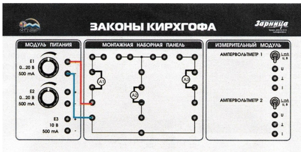
Рисунок 13.3 – Электрическая схема эксперимента
