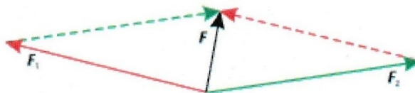
Рисунок 4.1 – Векторная сумма сил (параллелограмм сил)
