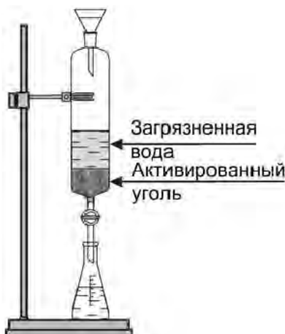
Рисунок 12. Установка для очистки воды адсорбцией
