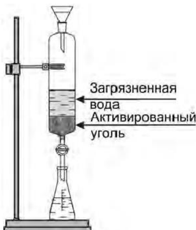
Рисунок 12. Установка для очистки воды адсорбцией
