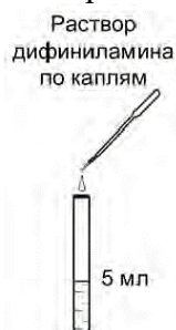
Рисунок 7. Обнаружение нитрат-ионов в исследуемой пробе воды
