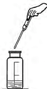
Рисунок 9. Соединение шприца-дозатора с пипеткой для титрования
