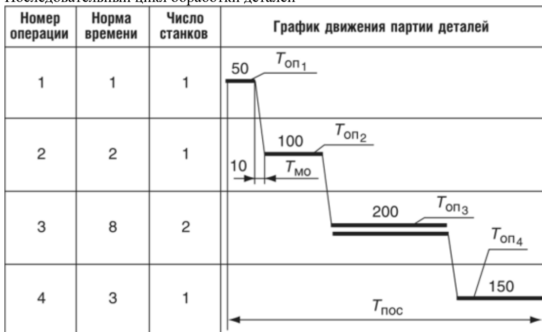
Рис. Последовательный цикл обработки деталей
