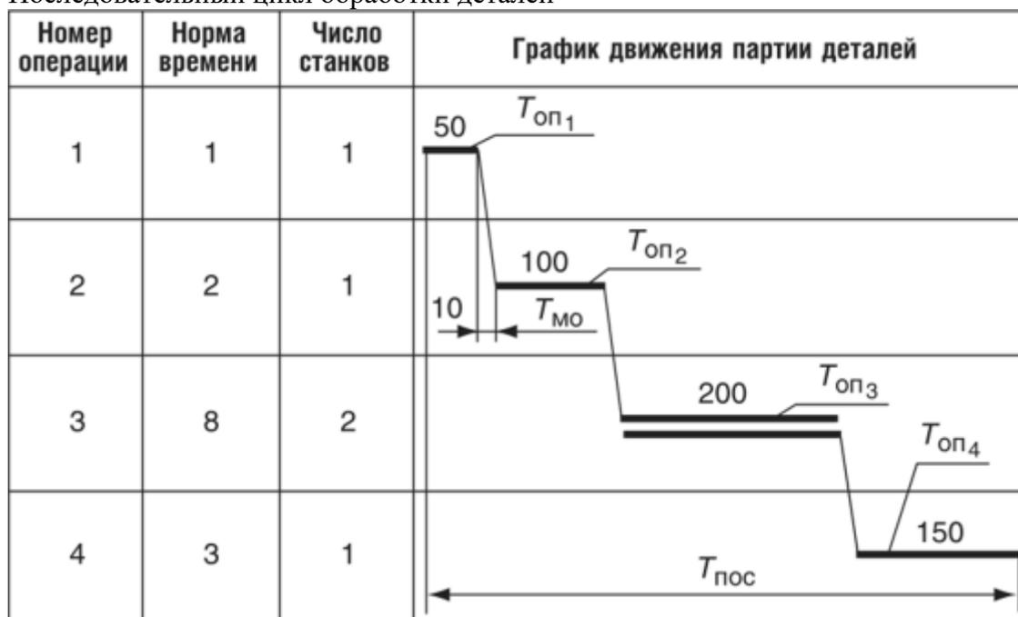
Рис. Последовательный цикл обработки деталей
