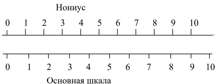
Рисунок 2.1 – Нониус и основная шкала
