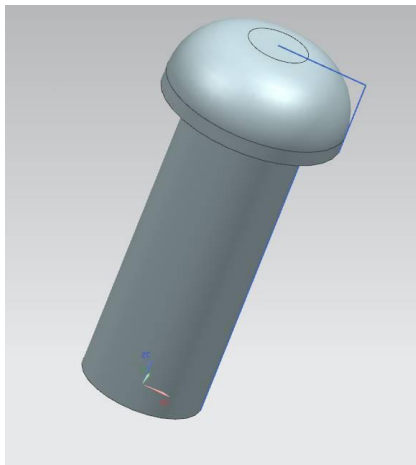
Рис. 3.5. Скругление «шляпки» болта
